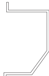
3 mm Blendenverstärkung für Einbruchschutzklasse 2 Je nach Einbausituation unterschiedlich
